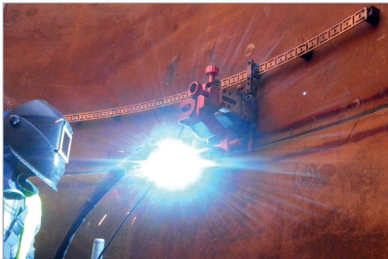
Гъвкави водещи релси Минимален радиус на огъване от 1.0 m PRW-0466-50-01-01-0
