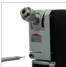
Прецизно регулиране на изпъкналостта на електрода.
