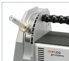
Ъгълът на заточване от 7,5 - 90° създава точни ъгли на върха на електрода от 15 - 180°.
