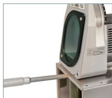
Прецизно регулиране на изпъкналостта на електрода.
